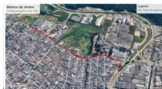
Figura 2 - Percurso do banco de dutos da SEP Iguatemi até a linha 15 do metrô monotrilho
